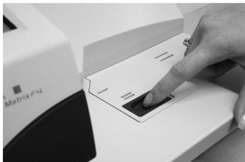
Ouvrez le compartiment d'étiquettes de l'alimentation MF4 en faisant glisser l'obturateur vers la droite. Ouvrez le couvercle en le poussant complètement vers la droite.
