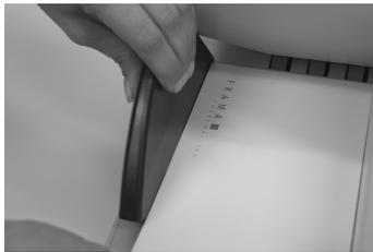
Déposez une petite partie de la pile à affranchir dans l'alimentation et maintenez solidement la pile. Poussez la butée latérale jusqu'à la pile puis relâchez-la.
