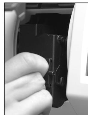
Relâchez les surfaces de préhension. Enfoncez la cassette d'impression vers l'arrière du bout du doigt afin de garantir que les crans d'arrêt soient correctement positionnés.
