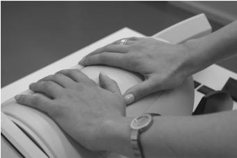
Appuyez sur le capot de transport des deux mains (pour ne pas le déformer) jusqu'à ce que le verrouillage s'enclenche et que le bouton de verrouillage regagne sa position à droite.
