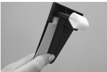
Nettoyez l'humidificateur ou remplacez-le. Insérez de nouveau l'humidificateur, installez de nouveau la fermeture de lettres dans l'AF6. Remplissez le réservoir d'eau et insérez-le.
