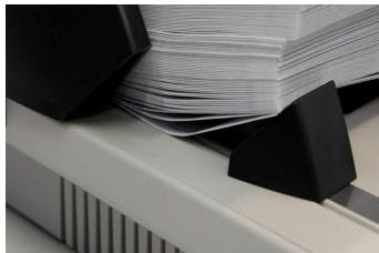
Veillez utiliser l'accessoire magnétique pour les enveloppes épaisses et/ou rigides. L'accessoire doit être placé sur le rail métallique à la hauteur du format marqué à traiter.
