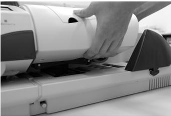
Glissez une main sous le capot de transport et relevez celui-ci jusqu'à ce qu'il s'enclenche. Remédiez au dysfonctionnement.
