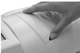
Ouvrez le compartiment d'étiquettes de l'alimentation AF6 en tirant vers le haut le capot supérieur pour l'ouvrir. Glissez un doigt sous le capot pour le relever. Ouvrez le capot en le tirant complètement vers le haut.
