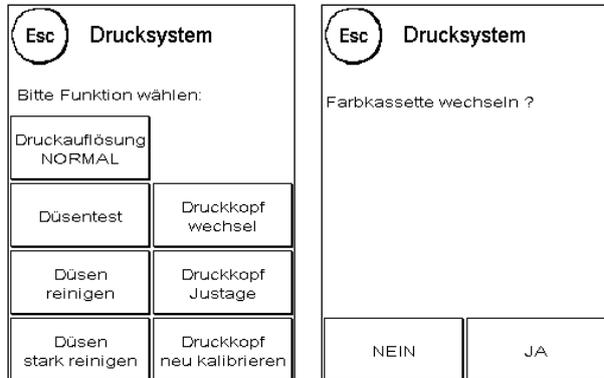
Setzen Sie eine neue Farbkassette ein. Vergewissern Sie sich, dass Sie vorher das Klebeband vom Druckkopf entfernt haben.
