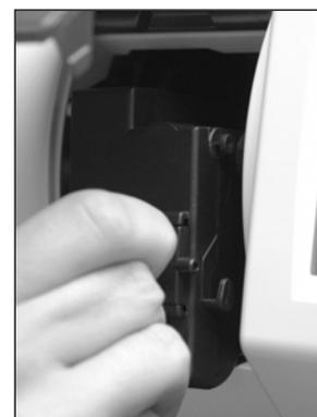
Lassen Sie die Druckflächen los. Drücken Sie die Farbkassette mit einem Finger nach hinten, um sicherzustellen, dass die Rastnasen korrekt positioniert sind.
