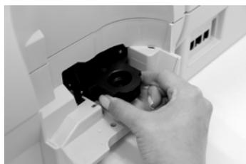
Lokalisieren Sie den Briefschließer. Fassen Sie diesen seitlich an und ziehen Sie den Briefschließer aus der Zuführung AF6 heraus.
