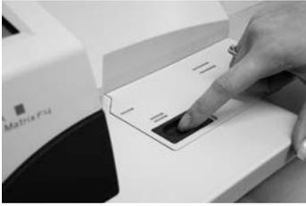
Öffnen Sie das Labelfach an der Zuführung MF4, indem Sie den Schieber nach rechts schieben. Öffnen Sie die Klappe vollständig nach rechts.
