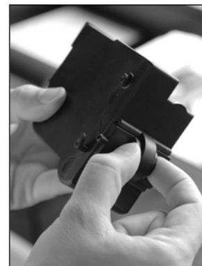
Öffnen Sie die obere Abdeckklappe. Der Druckschlitten befindet sich bereits in Warteposition zum Einsetzen der Farbkassette.
