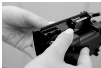
Halten Sie den Briefschließer mit einer Hand fest und entfernen Sie den Befeuchter.
