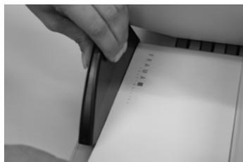
Legen Sie einen kleinen Teil des zu frankierenden Stapels in die Zuführung ein und halten Sie den Stapel fest. Schieben Sie den seitlichen Anschlag bis an den Stapel heran und lassen Sie ihn los.
