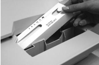
Entnehmen Sie eine Labelbox der Verpackung und schieben Sie die Box mit der linken Seite zuerst in den Schacht. Drücken Sie die Labelbox anschließend an der rechten Seite in die Führung.
