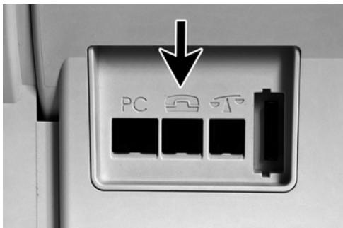
Verbinden Sie das Modemkabel (kleiner eckiger Stecker) mit dem Matrix Frankiersystem an der Buchse, die mit dem Telefonsymbol beschriftet ist.
