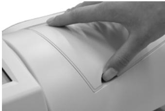
Öffnen Sie das Labelfach an der Zuführung AF6, indem Sie die obere Abdeckklappe nach oben hin öffnen. Greifen Sie mit einem Finger unter die Abdeckung und heben Sie diese an. Öffnen Sie die Klappe vollständig nach oben.
