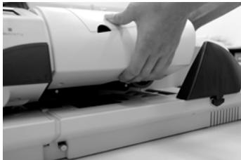
Fassen Sie mit einer Hand unter die Transportabdeckung und ziehen Sie diese nach oben, bis sie einrastet. Entfernen Sie die Störung.
