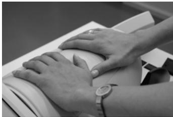
Drücken Sie die Transportabdeckung mit beiden Händen (um nicht zu verkanten) nach unten, bis die Verriegelung einrastet und der Verriegelungsschalter in seine rechte Position zurück fährt.
