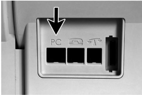
Benutzen Sie für den Anschluss einer externen PC-Lösung zur Datenübertragung die mit „PC“ gekennzeichnete Buchse. Bitte beachten Sie die Ausführungen in der Bedienungsanleitung der externen PC-Lösung.
