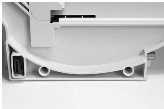
Abbildung 2: Man. Zuführung MF4 mit Führungslöchern
