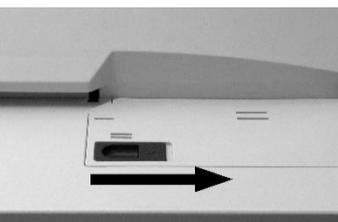
Öffnen Sie die Abdeckung des Labelsenders an der Zuführung, indem Sie die Abdeckklappe nach rechts hin öffnen. Schieben Sie mit einem Finger die Verriegelung nach rechts und heben Sie die Klappe an. Öffnen Sie die Klappe vollständig nach rechts.
