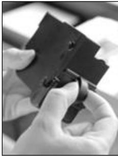
Entnehmen Sie die neue Farbkassette der Verpackung und entfernen Sie die zwei Schutzstreifen vom Druckkopf.
