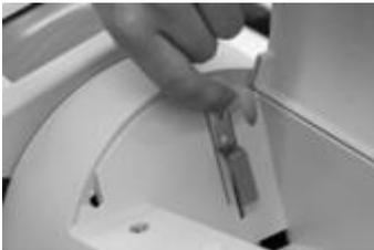
Fassen Sie mit der linken Hand den Hebel am oberen Ende an und ziehen Sie den Hebel nach oben. Halten Sie den Hebel in dieser Position. Entnehmen Sie ggf. die leere Labelbox.
