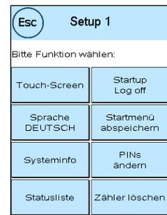
Mit der Pfeiltaste können Sie im Admin-Modus zu zwei weiteren Setup Menüs schalten, mit der ESC-Taste gelangen Sie wieder zurück.
