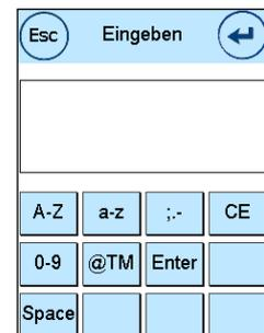
1. Drücken Sie die Taste „A-Z“ für die Eingabe eines Großbuchstabens. Mit der „Pfeil runter“ Taste erreichen Sie die weiteren Buchstaben. Drücken Sie den gewünschten Buchstaben. Drücken Sie die „Pfeil nach links“ Taste, um auf die Kleinbuchstaben umzuschalten.
