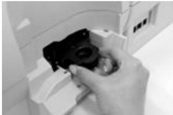
Lokalisieren Sie den Briefschließer auf der Rückseite der Zuführung. Die beiden Entriegelungsklinken am Schliessmodul drücken und aus der Zuführung AF / AFS herausziehen. **Achten Sie darauf, kein Wasser zu verschütten!**
