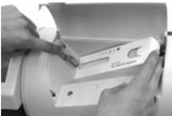
Setzen Sie die Etikettenbox in den Schacht. Das vordere, offene Ende der Etikettenbox wird unter den Hebel geschoben. Dann können Sie den Hebel loslassen.
