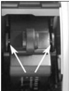
Lassen Sie die Druckflächen los. Drücken Sie die Farbkassette mit einem Finger nach hinten, um sicherzustellen, dass die Rastnasen korrekt positioniert sind und die Farbkassette richtig eingerastet ist.
