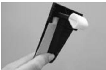
Reinigen Sie den Befeuchter oder tauschen Sie ihn aus. Setzen Sie den Befeuchter wieder ein, installieren Sie den Briefschließer wieder in der AF, füllen Sie den Wassertank auf und setzen Sie den Tank ein.
