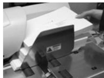
Abbildung links: Legen Sie einen kleinen Teil des zu frankierenden Stapels in die Zuführung ein und halten Sie den Stapel fest.
