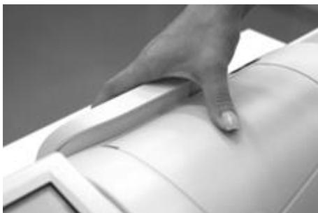
Entnehmen Sie den Wassertank von der Rückseite der Zuführung AF, indem Sie ihn nach oben ziehen.
