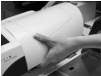
Fassen Sie mit einer Hand unter die Transportabdeckung und ziehen Sie diese nach oben, bis sie einrastet. Entfernen Sie liegengebliebene Briefe oder Papierreste.
