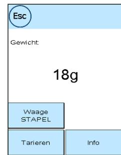
Mit der Taste „Waage Tariieren“ können Sie Ihre Waage auf Null stellen.
