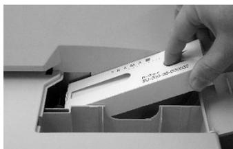
Setzen Sie die Labelbox nach links ein. Drücken Sie dazu mit einem Finger die Label leicht nach unten, um ein Herausrutschen zu verhindern. Schieben Sie die Box bis zum Anschlag nach links ein.
