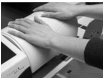
Drücken Sie die Transportabdeckung mit beiden Händen (um nicht zu verkanten) nach unten, bis die Verriegelung einrastet und der Verriegelungsschalter in seine rechte Position zurück fährt.
