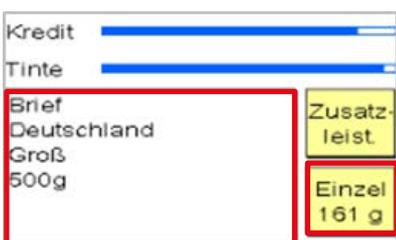
Der Brief wird im Einzelwiegemodus gewogen und das Porto wird berechnet.
