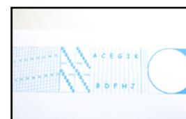
Hat der Testdruck die gewünschte Qualität, ist der Reinigungsvorgang abgeschlossen. Falls nicht, wiederholen Sie die Nassreinigung.
