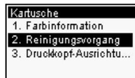
Anschliessend können Sie den Punkt „Reinigungsvorgang“ auswählen und die Kassette wird gereinigt.
