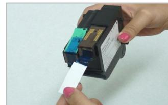
Die Schutzstreifen vom Druckkopf der neuen Kassette entfernen. Goldkontakte nicht berühren.
