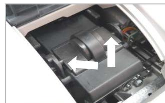
Die Druckflächen loslassen und kontrollieren, dass die Rastnasen seitlich eingerastet sind.
