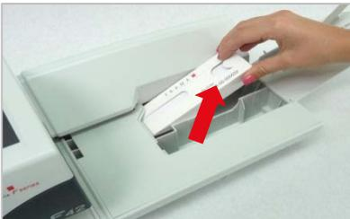
Die neue Labelbox einsetzen und bis zum Anschlag nach links schieben. Etiketten in der Aussparung (Pfeil) mit dem Zeigefinger festhalten.
