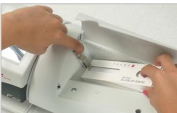
Den Hebel in der Öffnung wieder nach oben ziehen und das linke Ende der neuen Labelbox unter den Hebel schieben.
