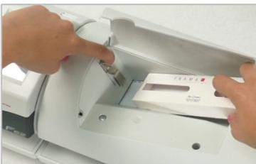
Den Hebel in dieser Position halten und die leere Labelbox nach rechts herausziehen.
