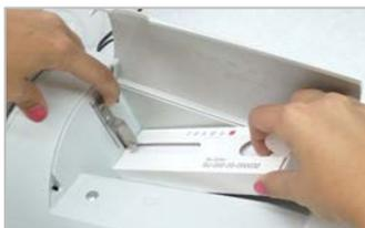
Die Labelbox in der Abdeckung einsetzen.
