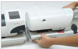
Knopf der Zuführung drücken und diese an die Frankiermaschine koppeln.
