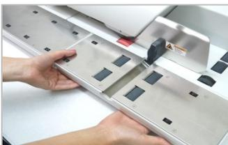
Die Tische positionieren und den Hebel unter den Tischen drehen, um diese zu befestigen.
