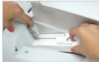
Die Labelbox in der Abdeckung einsetzen.
