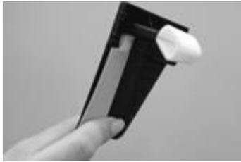
Nettoyez l'humidificateur ou remplacez-le. Insérez à nouveau l'humidificateur, réinstallez le système de fermeture dans l'AF, remplissez le réservoir d'eau et insérez-le.
