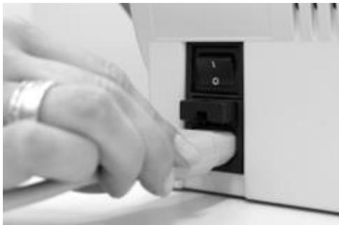
Vérifiez que vous avez bien fermé tous les couvercles du système d'affranchissement Matrix. Veillez à ce que la plateforme de pesée soit libre. Vérifiez que le système est arrêté (le 0 doit être enfoncé).
