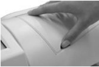
Ouvrez le compartiment du distributeur d'étiquettes de l'alimentation AF /AFS en basculant le capot supérieur contre le haut. Glissez un doigt sous le capot pour le soulever. Ouvrez le capot en le tirant complètement vers le haut.
