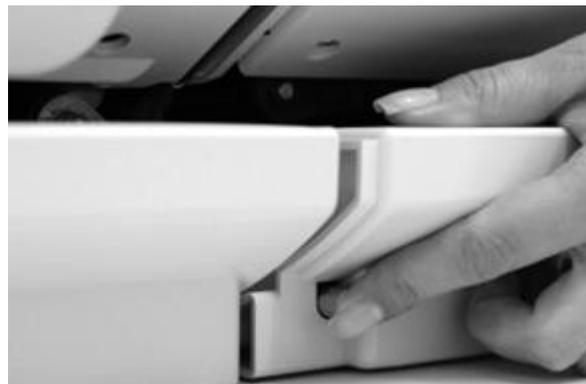
Figure 4 : alimentation AF / AFS pas encore verrouillée !
