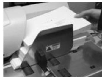
Figure de gauche : Déposez une petite partie de la pile à affranchir dans l'alimentation et maintenez solidement la pile.
