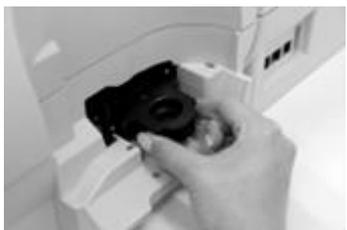
Mettez en place le système de fermeture au dos de l'alimentation. Appuyez sur les deux poignées de déverrouillage du module de fermeture et sortez-le de l'alimentation AF / AFS. **Veillez à ne pas renverser d'eau !**
