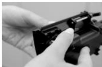
Maintenez le système de fermeture d'une main et enlevez l'humidificateur.
