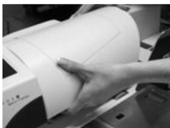
Glissez une main sous le capot de transport et relevez celui-ci jusqu'à ce qu'il s'engage. Éliminez le dysfonctionnement.
