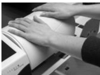
Appuyez sur le capot de transport avec les deux mains (pour éviter qu'il reste croché) jusqu'à ce que le verrouillage s'engage et que le bouton de verrouillage revienne dans sa position à droite.
