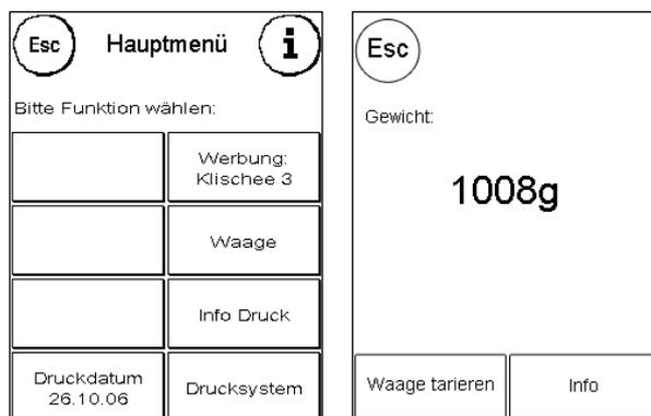
Wählen Sie „Waage“. Sie befinden sich im Waagenmenü. Platzieren Sie Ihre Sendungen auf der Waage. Das Gewicht wird angezeigt. Mit der Taste „Waage tarieren“ können Sie Ihre Waage auf Null stellen.
