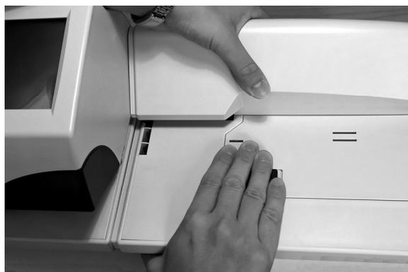
Abbildung 6: Verbinden von Zuführung und Matrix F4
