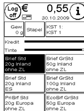
Geben Sie die Anzahl der Sendungen pro Stapel ein. Starten Sie die Abarbeitung des Stapels mit der OK Taste oder durch einen Druck auf die eingegebene Zahl.
