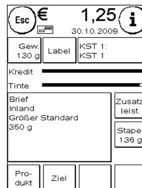
Nehmen Sie einen Brief vom Stapel. Der Bildschirm schaltet in den Stapelwiegemodus um. Die Taste „Gewicht“ wird ausgeblendet. Basierend auf dem Gewicht des vom Stapel genommenen Briefes wird das Porto berechnet. Frankieren Sie den Brief.
