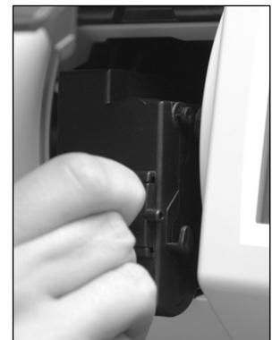
Lassen Sie die Druckflächen los. Drücken Sie die Farbkassette mit einem Finger nach hinten, um sicherzustellen, dass die Rastnasen korrekt positioniert sind.
