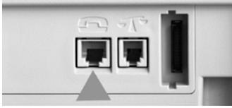
Conecte el cable del módem (clavija pequeña cuadrada) al enchufe con el símbolo del teléfono en la Matrix F2.
