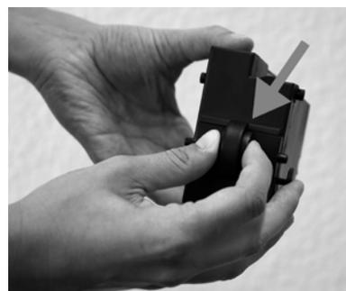
Abra la tapa superior de cierre de la Frama Matrix F2. El deslizador de impresión se encuentra en posición de espera para colocar el cartucho de tinta.
