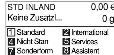
2. Verwenden Sie das Tastenfeld zur Auswahl eines Produkts, einer Zusatzleistung oder eines Sondertarifs.
