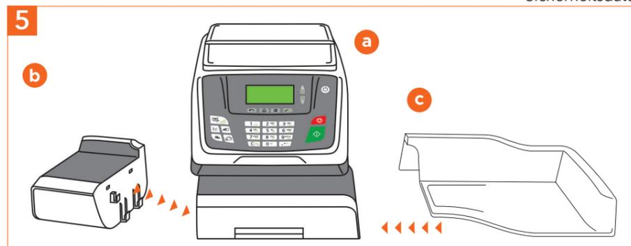
5 Heben Sie das Gerät an der linken Seite etwas an und richten Sie die Rasten aufeinander aus, um die Zuführung (b) anzubringen. Befestigen Sie auf dieselbe Weise die Auffangschale (c) rechts am Gerät.
