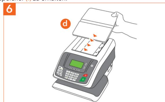
6 Klappen Sie die Abdeckung der Wiegeplattform nach hinten ab. Setzen Sie die Wiegeplattform (d) auf das Gerät und schieben Sie sie nach vorne, bis sie einrastet. Heben Sie die Abdeckung etwas an, um das Anschlusskabel einstecken und sichern zu können.
