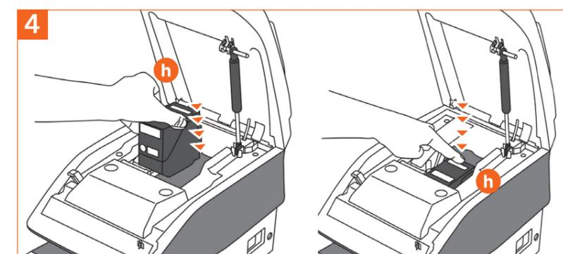
4 Setzen Sie die Farbkartusche (h) schräg in das Gerät ein, wobei die Beschriftungen TOP und LOCK nach oben zeigen müssen. Drücken Sie die Kartusche (h) nach hinten, bis ein Klicken zu hören ist. Dann schließen Sie die Geräteabdeckung wieder.
