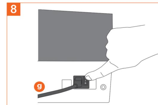
8 Schalten Sie das Gerät durch Drücken des Betriebsschalters hinter dem Netzkabel (g) ein und befolgen Sie die Anweisungen am Display.
