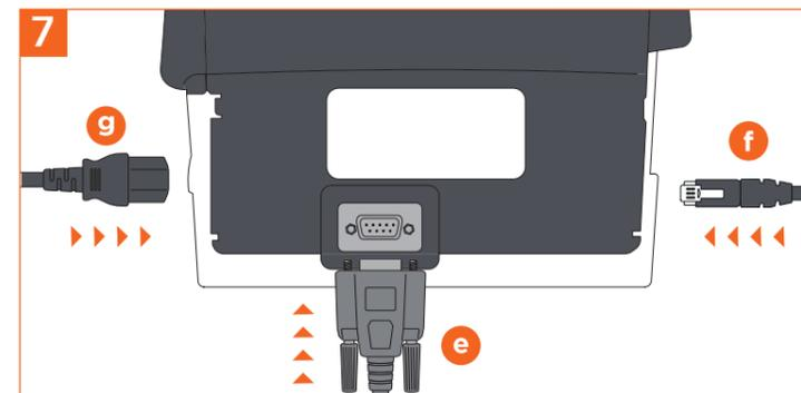
7 Schließen Sie das Kabel für die Wiegeplattform (e) am COM-Anschluss an der Geräterückseite an. Schließen Sie dann das LAN-Kabel (f) und das Netzkabel (g) an der jeweiligen Geräteseite an.
