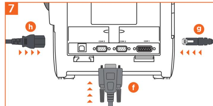
7 Schließen Sie das Kabel für die Wiegeplattform (f) am COM-Anschluss an der Geräterückseite an. Schließen Sie dann das LAN-Kabel (g) und das Netzkabel (h) an der jeweiligen Geräteseite an.
