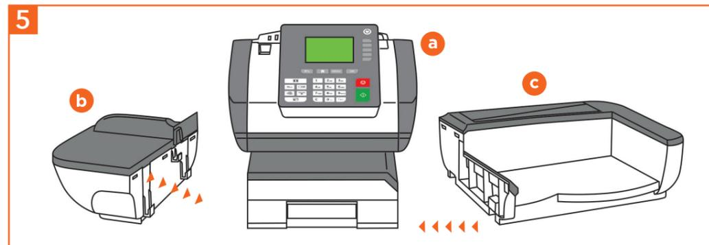
5 Heben Sie das Gerät an der linken Seite etwas an und richten Sie die Rasten aufeinander aus, um die Zuführung (b) anzubringen. Befestigen Sie auf dieselbe Weise die Auffangschale (c) rechts am Gerät.
