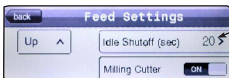
Nach dem Drücken des Leerlaufabschaltwerts öffnet sich eine Nummerntastatur zum Einstellen der Ziffer. Die Ziffer muss gleich oder zwischen 20 und 600 Sekunden sein.
