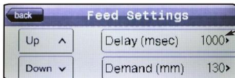
Nach dem Drücken des On Delay-Werts öffnet sich eine Nummerntastatur zum Einstellen der Ziffer. Die Ziffer muss gleich oder zwischen 1 und 10.000 Millisekunden liegen.
