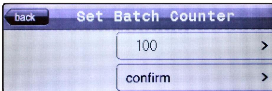
Die Zahl im oberen Eingabefeld ist der augenblicklich eingestellte Stapelzählerwert. Um diesen Wert zu ändern, drücken Sie auf dieses Feld. Nach dem Drücken erscheint eine Nummerntastatur, mit der der Zahlenwert geändert werden kann. Der Stapelzähler kann auf gleich oder zwischen 1 und 10.000 eingestellt werden. Drücken Sie nach Eingabe des Werts das confirm-Feld, um den eingestellten Stapelzählerwert zu bestätigen.
