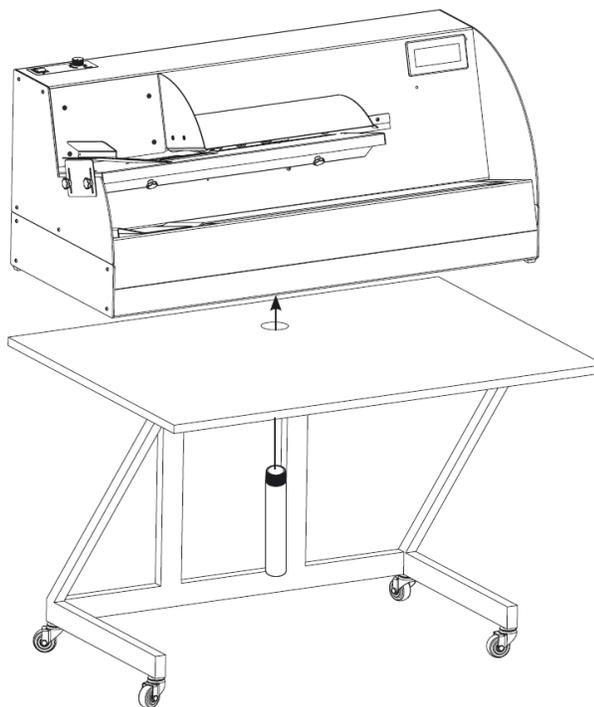
Positionieren Sie den Abfallbehälter wie in untenstehender Abbildung so unter der Maschine, dass er sich zentral unter dem Abfallrohr befindet.
