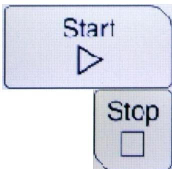
Durch Drücken der Start-Taste startet der eingestellte Stapel. Die Maschine läuft solange weiter bis die Stop-Taste gedrückt wird oder der Stapel vollständig bearbeitet wurde.
