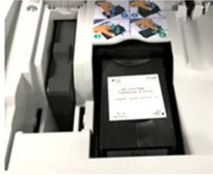
1. Öffnen Sie die Abdeckung: Die Kartusche bewegt sich an die Position, an der die Entnahme erfolgen soll.
