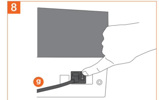
8 Schalten Sie das Gerät durch Drücken des Betriebsschalters hinter dem Netzkabel (g) ein und befolgen Sie die Anweisungen am Display.
