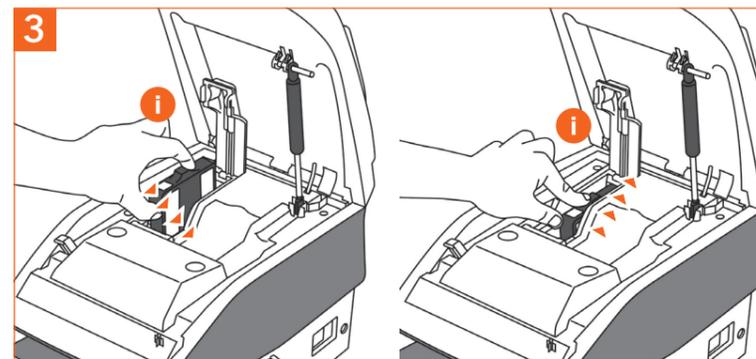
3 Öffnen Sie die Abdeckung. Legen Sie den postalischen Sicherheitsdatenspeicher (i) in das entsprechende Fach ein und drücken Sie ihn nach hinten, bis er einrastet.
