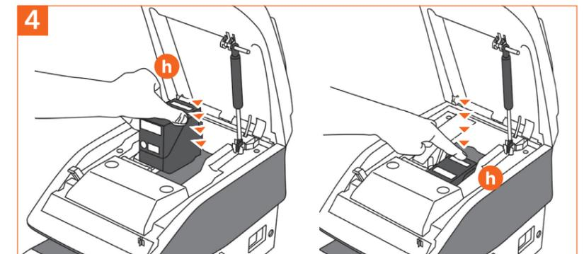
4 Setzen Sie die Farbkartusche (h) schräg in das Gerät ein, wobei die Beschriftungen TOP und LOCK nach oben zeigen müssen. Drücken Sie die Kartusche (h) nach hinten, bis ein Klicken zu hören ist. Dann schließen Sie die Geräteabdeckung wieder.
