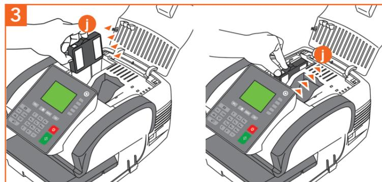
3 Öffnen Sie die Abdeckung. Legen Sie den postalischen Sicherheitsdatenspeicher (j) in das entsprechende Fach ein und drücken Sie ihn nach hinten, bis er einrastet.
