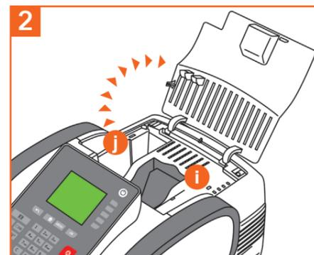
2 Klappen Sie die Geräteabdeckung auf, um Zugang zu den Fächern für die Farbkartusche (i) und den postalischen Sicherheitsdatenspeicher (j) zu erhalten.
