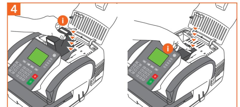
4 Setzen Sie die Farbkartusche (i) schräg in das Gerät ein, wobei die Beschriftungen TOP und LOCK nach oben zeigen müssen. Drücken Sie die Kartusche (i) nach hinten, bis ein Klicken zu hören ist. Dann schließen Sie die Geräteabdeckung wieder.
