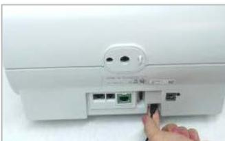
Das Stromkabel (Winkelstecker) hinten an die Frankiermaschine anschliessen.
