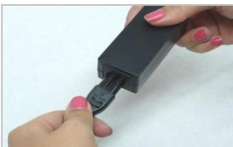
Das Netzkabel in das Netzteil stecken.
