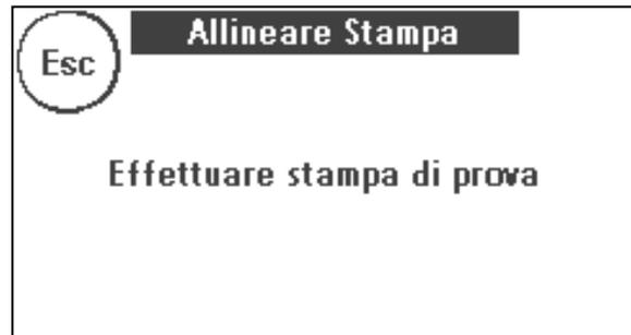
L'elemento di affrancatura viene stampato con una figura di prova ed espulso verso sinistra. Così appare la stampa di prova: nella parte di sinistra vedete l'allineamento in X e, nella parte di destra, l'allineamento in Y. La regolazione valida in ciascuno dei due casi è indicata con una freccia. Le frecce indicano il punto in cui appaiono le linee più diritte.
